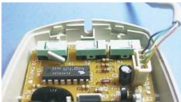
Fig. 47: O botão do meio pode ser colocado no lugar de um botão defeituoso
