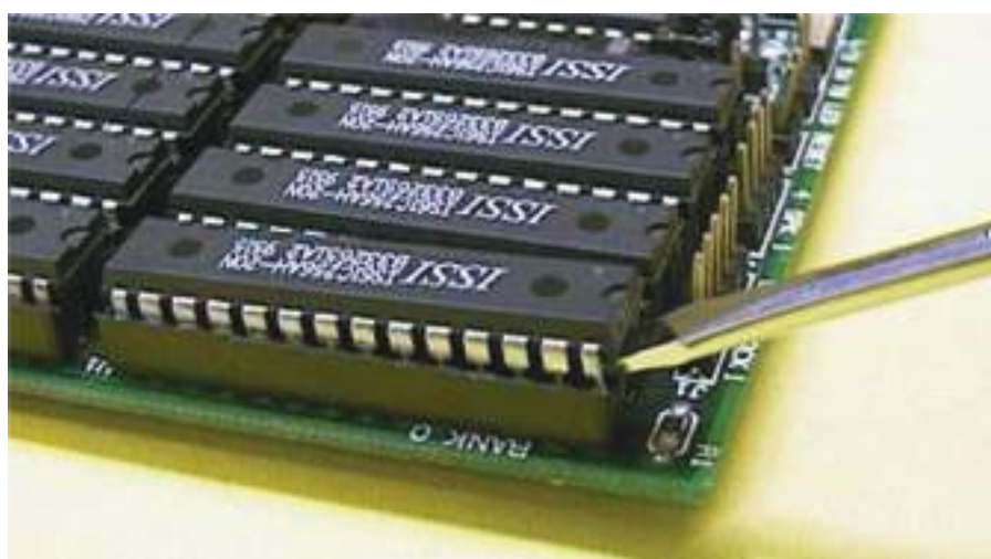
Fig. 20: Extração de um chip com o auxílio de uma chave de fendas
