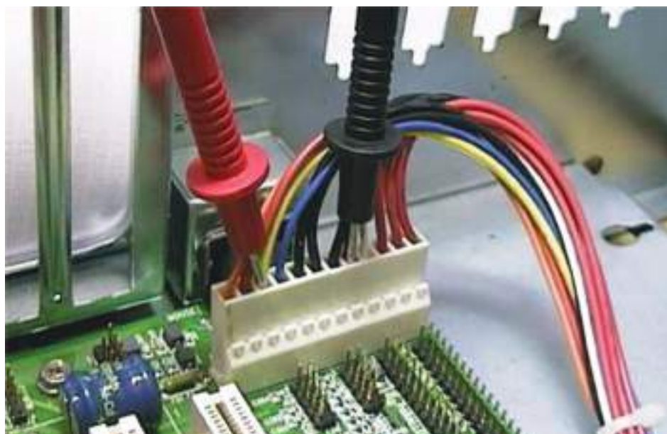
Fig. 15: A medir as tensões da fonte com um multímetro digital
